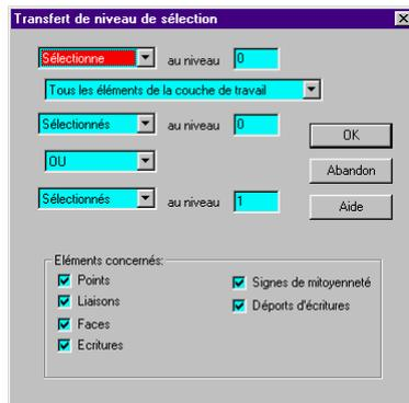
Il existe 32 niveaux de sélection (de 0 à 31). On peut donc combiner les éléments sélectionnés sous différents niveaux par des opérations logiques. Il est possible de n'intervenir que sur certains types d'éléments (cf ci-contre : la fenêtre parle d'elle-même.)
