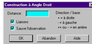
Chaque fois que OK est appuyé, le point ainsi calculé est écrit, la liaison est tracée de l'extrémité à ce nouveau point qui devient la nouvelle extrémité si l'option "trace liaison" est cochée, le calcul effectué pour calculer le point est sauvegardé sous forme de rayonnement si l'option "sauve l'observation" est cochée., et enfin la direction d'origine devient la direction de l'ancienne extrémité au point devenu la nouvelle extrémité.
